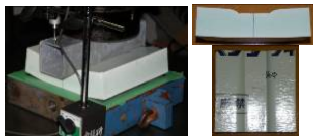
写真2 型枠変形状況の例 (支圧実験: t=50\text{mm} )
