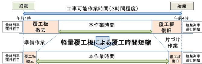
図2. 夜間工事のタイムスケジュールの例
