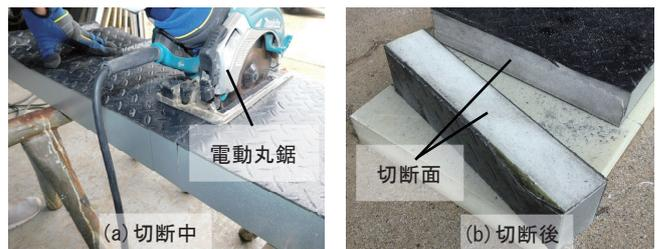
写真3. 木工工具（電動丸鋸）での切断
