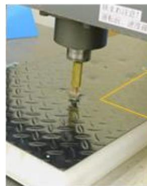
写真3 軽量覆工板変形状況（支圧実験）
