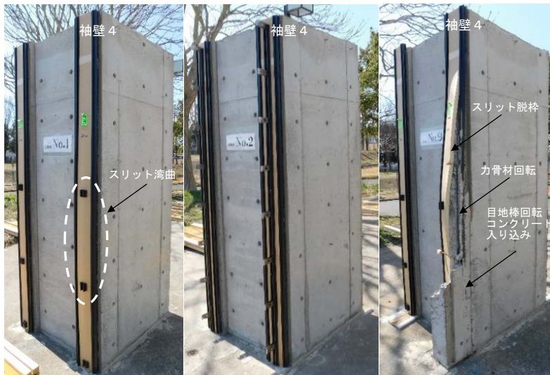
試験体 No. 1 試験体 No. 2 試験体 No. 5 写真2 スリット変形状況
