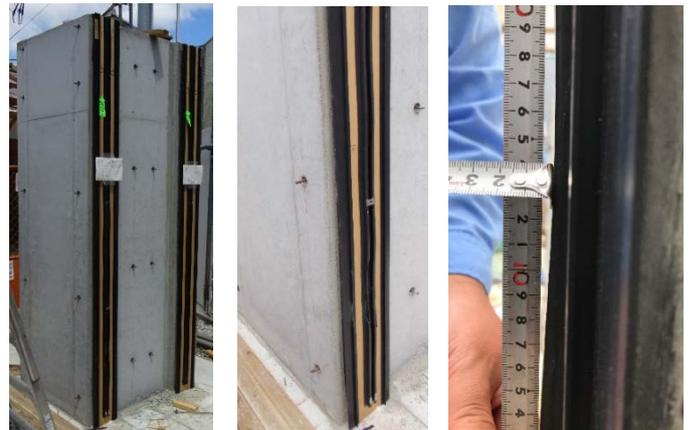
写真2. スリット変形状況(柱1)
