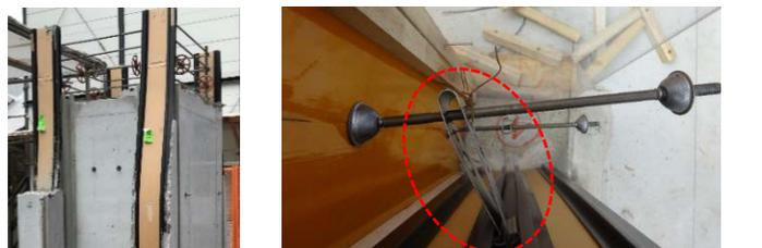
写真3. 固定金物変形状況(柱1)
