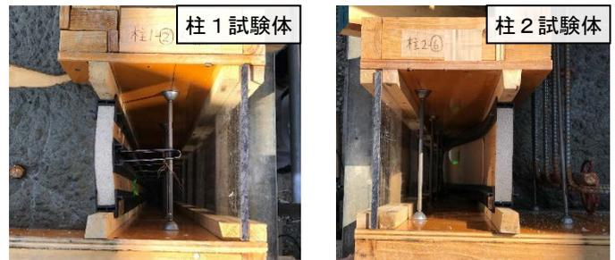
写真1. コンクリート打設後のスリット
